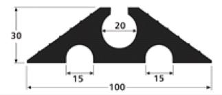
Passage de câble souple pour Véhicules – Noir - Usage temporaire ou peu intensif – FENDU SUR LE DESSUS – Elastomère
